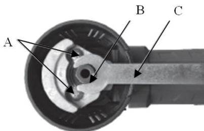
Для монтажа/демонтажа шлифтарелки зафиксируйте шпindel (B) с помощью ключа (C). Продолжая удерживать ключ, отверните ручную шлифтарелку против часовой стрелки, чтобы ее отсоединить. Для присоединения шлифтарелки произведите все операции в обратном порядке.
