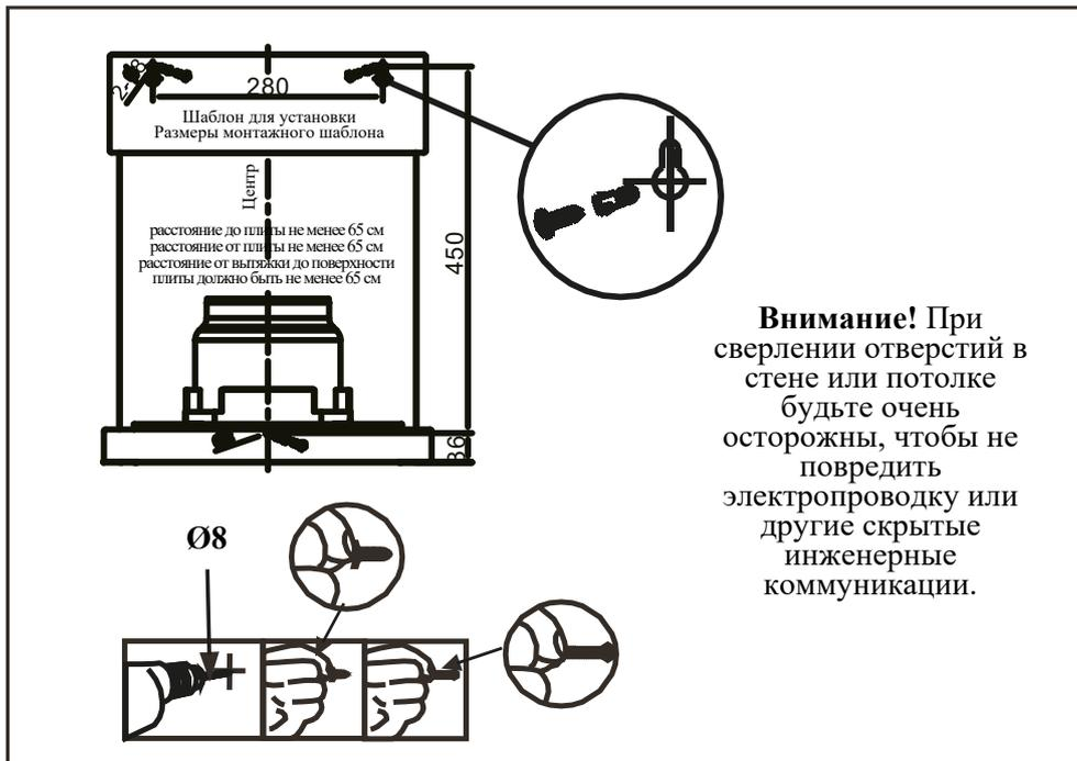
В соответствии с рис. 3 убедитесь в правильном расположении вытяжки на стене. Затем с помощью трафарета просверлите в стене три отверстия диаметром 8 мм. Закрепите три комплекта дюбелей и шурупов, в этих отверстиях.
