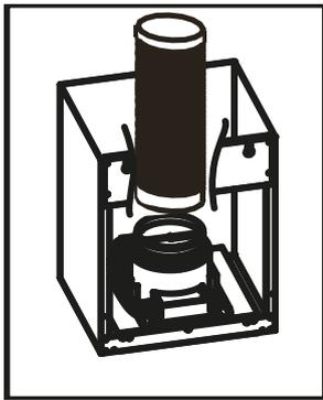
Кухонная вытяжка имеет конструкцию, позволяющую устанавливать различные направления вентиляции.
