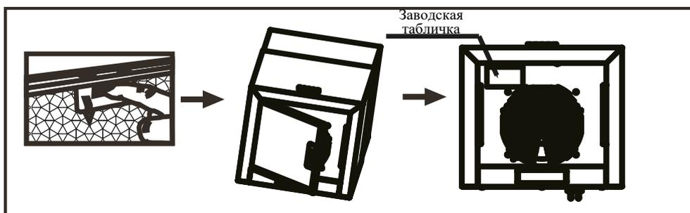
Проверьте напряжение и частоту, указанные на заводской табличке, расположенной на внутренней стороне вытяжки.
