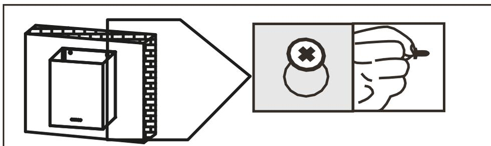
Закрутите все четыре винта, сначала закрутите два верхних винта, затем закрутите два нижних винта.
