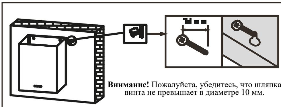
Повесьте вытяжку так, чтобы ее 3 монтажных отверстия были направлены на 3 винта, и закрепите ее в этом положении.
