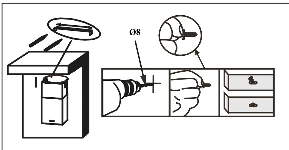
Установите фиксатор дымохода в соответствующее положение на стене.
