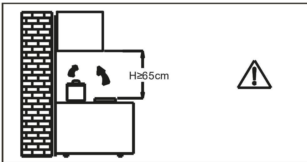
Мы рекомендуем, чтобы после установки нижняя часть вытяжки находилась на расстоянии не менее 650 мм и не более 750 мм над нагревательными элементами и конфорками варочной поверхности.
