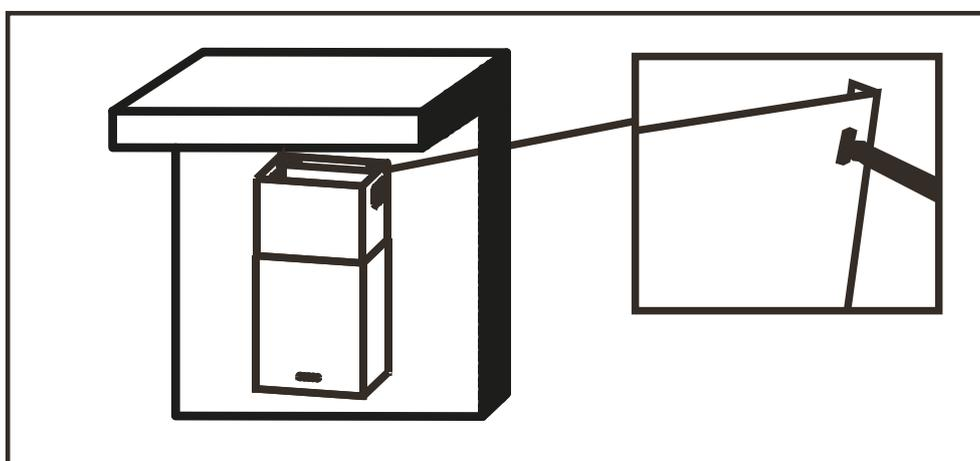
Используйте винт ST4\*10 для соединения неподвижной опоры дымохода и верхнего дымохода.
