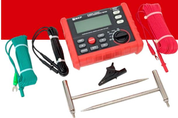
Прибор предназначен для измерения напряжения заземления, сопротивления заземления различного оборудования, мониторинга и планирования систем защиты от молний, измерения сопротивления с помощью вспомогательных заземлителей. Может проводиться в двух режимах измерения: двухпроводном и трехпроводном.
