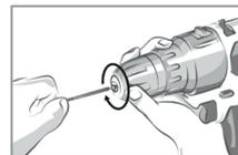
6.1.7 Установите рабочий инструмент и зафиксируйте его путем вращения муфты патрона в обратную сторону.
