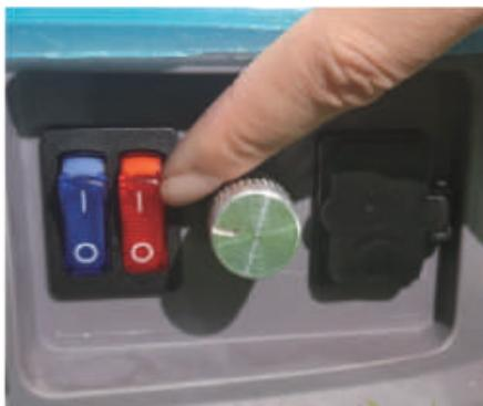
**6. TORNADO PRO** оснащен двойной помпой. На корпусе расположено два переключателя, каждый управляет одной из помп. В зависимости от условий использования можно использовать 1 или 2 помпы одновременно. Для использования 2-х помп оба переключателя должны находиться в режиме ВКЛ. Дополнительно доступна плавная регулировка давления. Вращением ручки регулировки давления выберите необходимое давление.
