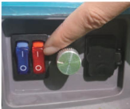
6. Дополнительно доступна плавная регулировка давления. Вращением ручки регулировки давления выберите необходимое давление.
