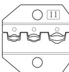
Опрессовка изолированных разъемов с красной, синей и желтой манжетами
