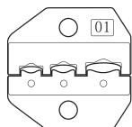
Опрессовка изолированных наконечников и гильз с красной, синей и желтой манжетами
