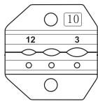
Опрессовка наконечников, разъемов и гильз с термоусаживаемой изоляцией и концевых изолирующих заглушек КИЗ
