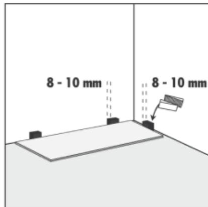
1. Перед началом монтажа непосредственно напольного покрытия на основание необходимо уложить полиэтиленовую пленку толщиной не менее 200мкм. Поверх пленки необходимо уложить подложку высокой плотности для LVT, толщиной не более 2мм. Между стеной и краем плитки необходимо оставить зазоры толщиной 8-10мм. Первый ряд укладывается шипом к стене.
