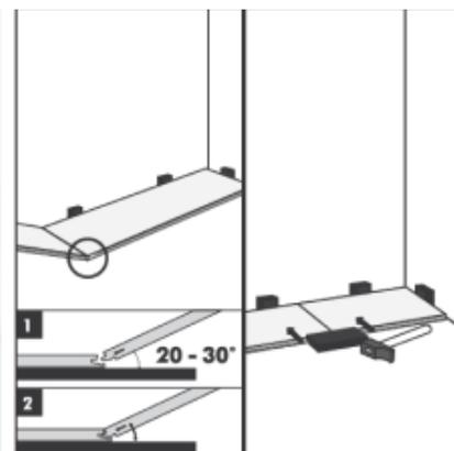
2. В паз торцевой стороны первой панели вставьте шип следующей панели под углом примерно 20-30 градусов. Опустите панель, запирая замок.
