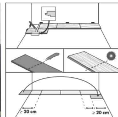
3. Продолжайте соединять первый ряд, пока не дойдете до последней целой панели. Установите последнюю панель, повернув на 180 градусов рисунком вверх. Измеряйте и отмечайте, затем, используя линейку и универсальный нож, прорежьте панель по линии отметки и отламывайте. Прикрепляйте, как описано выше.
