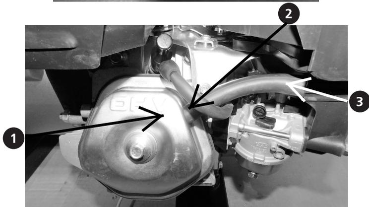
При повышении температуры выше -15°С, вынуть пробку из резиновой трубки **2** и присоединить трубку к клапанной коробке. **1**
