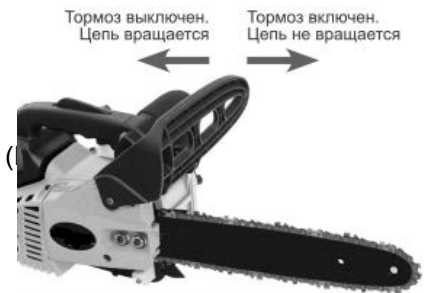
Рис. 6 Проверка механического тормоза цепи
