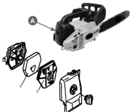
Рис. 18 Обслуживание воздушного фильтра
