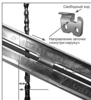
Рис. 22 Расположение линии угла заточки
