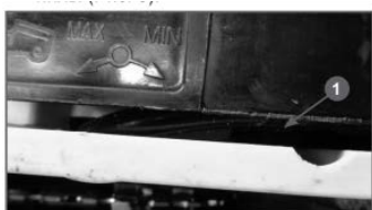
Рис. 8 Винт регулировки подачи масла
