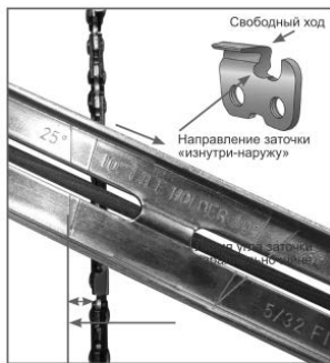
Рис. 22 Расположение линии угла заточки
