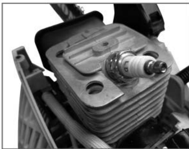
Рис. 28 Охлаждающие ребра цилиндра
