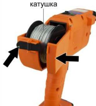
Произведите пробную вязку. Если проволока не выходит из направляющей насадки, попробуйте переустановить катушку.
