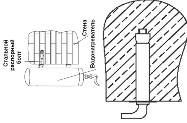
отверстия на одной и той же высоте глубина и диаметр которых зависят от технических характеристик конкретной модели водонагревателя и крепежа, поставленного в комплект. Расстояние между отверстиями должно быть 215 мм.
