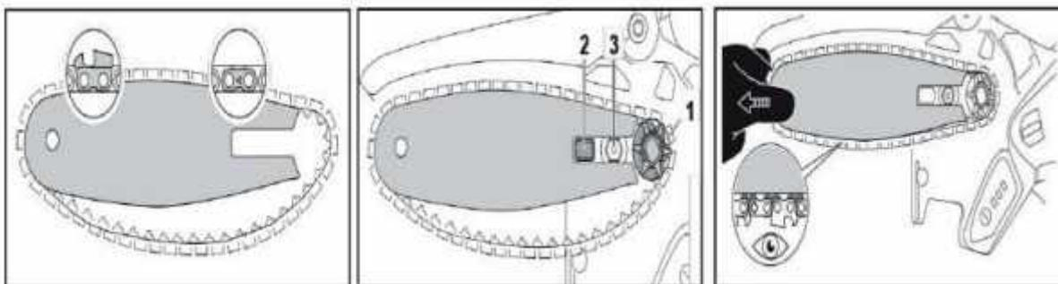
1. Установите шину на несущий болт. Расположите шину максимально близко к ведущей звезде и наденьте цепь на ведущую звезду.
