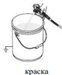
7. Прижмите краскораспылитель к ведру с краской. Снимите предохранитель краскораспылителя. Нажмите на спусковой механизм краскораспылителя и увеличивайте давление увеличения до появления промывочной жидкости.
