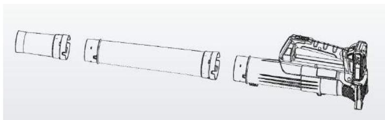
1. Совместите самый широкий конец трубки воздуходувки с передним отверстием воздуходувки.
