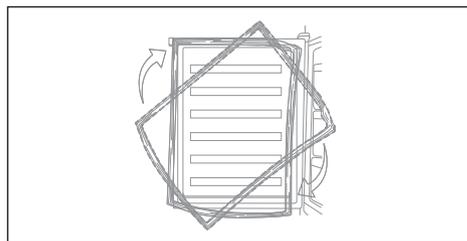
14. Установите нижнюю дверь, проверьте, чтобы уплотнитель двери плотно прилегал к холодильнику и закрепите её средней петлей на холодильнике.
