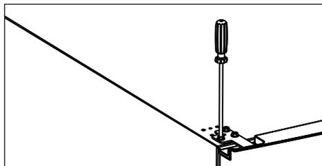
15. Установите верхнюю дверь, проверьте, чтобы уплотнитель двери плотно прилегал к холодильнику. После этого зафиксируйте дверь верхней петлей.
