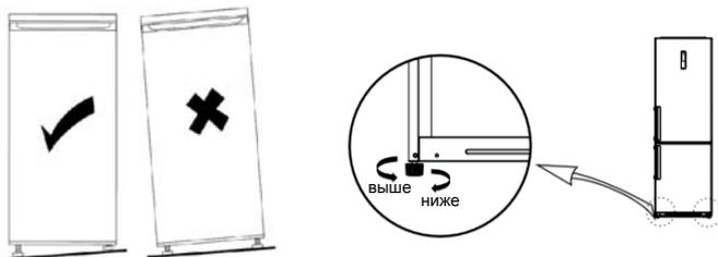
**ПРИМЕЧАНИЕ.** Регулировку рекомендуется проводить вдвоем. Отрегулировать положение ножек будет легче, если наклонить изделие назад, нажимая на верхний край. Чтобы избежать опрокидывания, не наклоняйте изделие более чем на 45 градусов.
