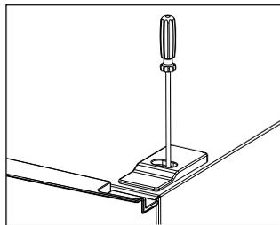
7. Снимите верхнюю дверь, открутив среднюю петлю, потом снимите нижнюю дверь.
