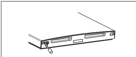
13. Отсоедините изоляцию дверцы холодильной и морозильной камеры, а затем переверните и закрепите их обратно.
