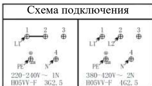
между рабочими контактами предохранительного выключателя должно составлять не менее 3 мм. Перед подключением керамической варочной панели к источнику питания важно ознакомиться с информацией на табличке с техническими данными и схемой подключения.
