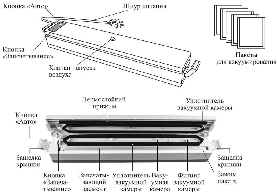
**Кнопка «Авто»** — кнопка для автоматической упаковки. Вакууматор удалит воздух, а затем запечатает пакет. Повторное нажатие на кнопку во время процесса прерывает работу.
