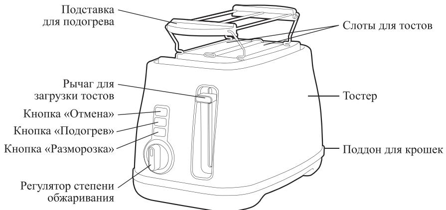
С помощью *регулятора степени обжаривания* настраивается степень обжарки тостов от «1» до «6». «1» — означает минимальное время и легкую (светлую) обжарку, «6» — максимальное время и сильную (темную) обжарку.
