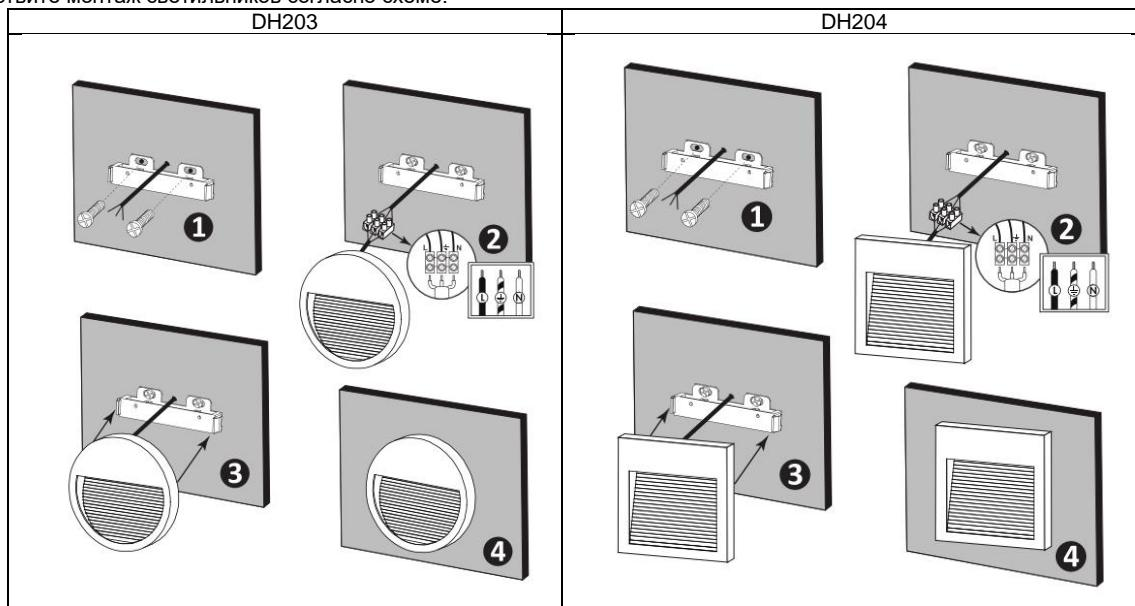
4.3 Предварительно обесточьте и подготовьте к подключению кабель питающей сети. Проштробите в стене кабельный канал, подведите питающий кабель к месту установки. Кабель должен содержать три провода: фазовый, нейтральный и провод защитного заземления.
