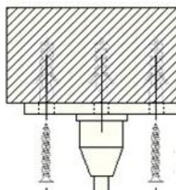
1. Просверлите отверстия в потолке. Для определения положения отверстий используйте круглую оконцовку тросса.
