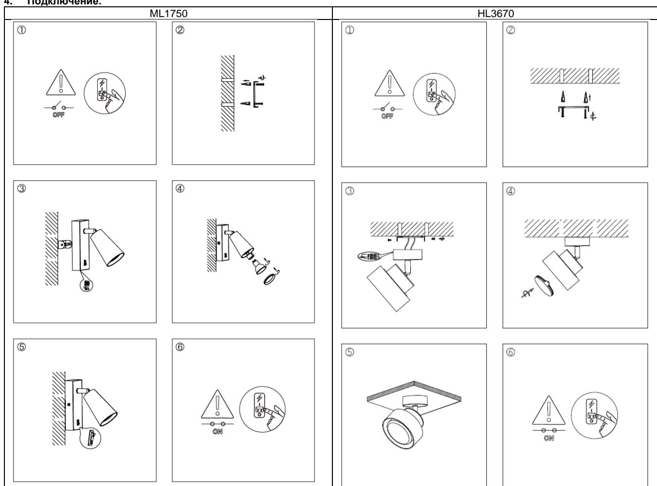
4.1 Соедините провода питающей сети с проводами, идущими на светильник. Подключите коричневый провод светильника к фазному контакту, а синий провод к контакту нейтрали питающей сети при помощи клеммной колодки (в комплекте поставки).
