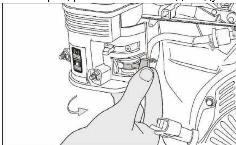
Рис. 34. Открытие топливного крана
