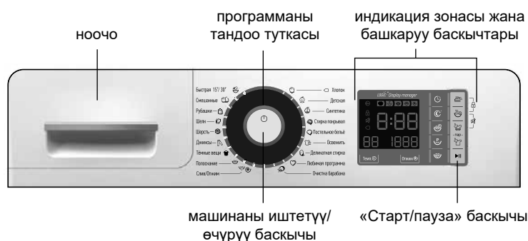
1-сүрөт – Башкаруу панели
