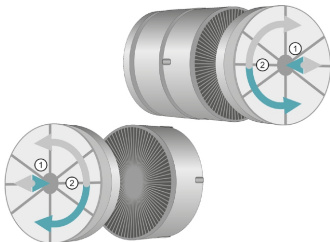
Рис. 14 Установка угольного фильтра
