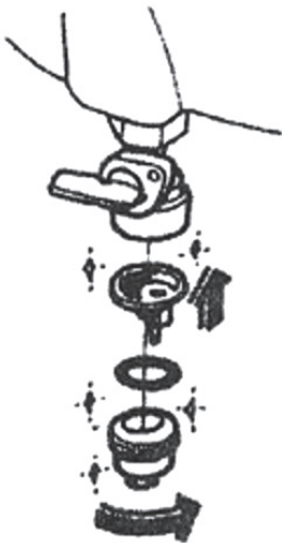
Установка фильтрующего элемента
