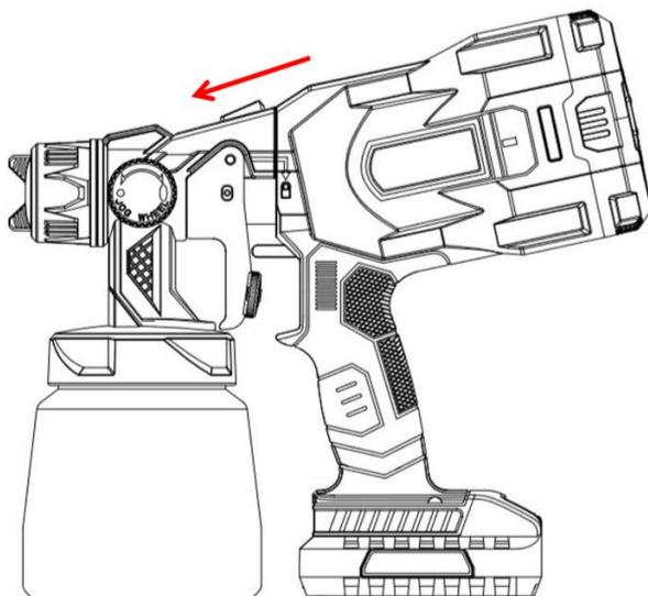
5. Соедините корпус пистолета с двигателем
