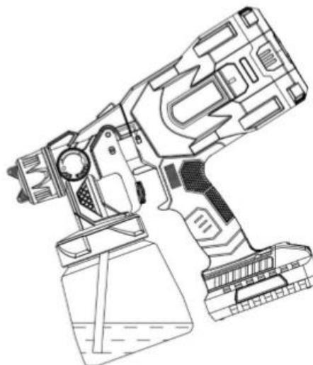
Б) Если распылитель направлен вниз, то угловой конец всасывающей трубки должен быть направлен в переднюю часть пистолета
