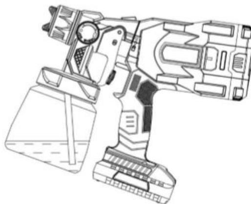
А) Если распылять в направлении вверх, то угловой конец всасывающей трубки должен быть направлен в заднюю часть пистолета
