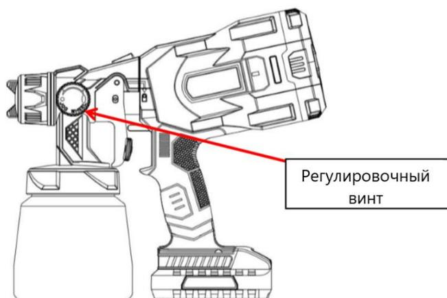
7. Регулировка длины распыления: поверните эту ручку, чтобы отрегулировать форму по вертикали и горизонтали. Отрегулируйте необходимую длину в соответствии с условиями распыления, уменьшите расход и сохраните материал.
