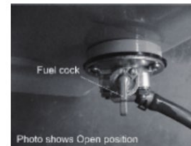
Топливный кран На снимке показано открытое положение.
