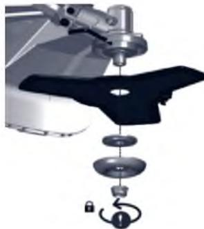
3.5. Отпуск лезвия. Для того, чтобы снять лезвие, зафиксируйте фланец отверткой и отпустите гайку.
