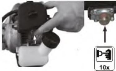
2. Переведіть вимикач двигуна в положення ON. "I" (ON)
