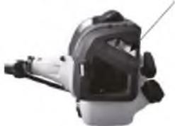
Загрязненный воздушный фильтр уменьшает производительность двигателя. Проверьте и почистите элемент воздушного фильтра в теплом слабо-мыльном растворе. Промойте его и хорошо высушите перед установкой. Если элемент поврежден, то его необходимо заменить.
