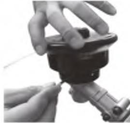
**3.3 Зняття косильної головки. Використовуючи викрутку для фіксації фланця, поверніть косильну головку за годинниковою стрілкою, викрутіть її повністю з різьби та зніміть.**
