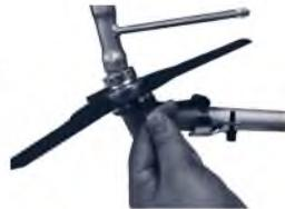
**3.5 Відпускання леза. Для того, щоб зняти лезо, зафіксуйте фланець викруткою та відпустіть гайку.**
