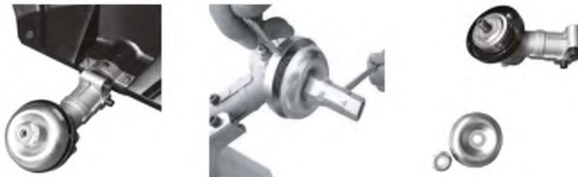
3.2. Установка косильной головки. После отпуска гайки снимите защитный щит.
