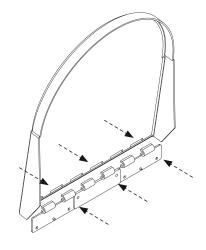
Установить крепежный кронштейн  ${\bf D}$  на боковой стенке, выполнить установку держателя  ${\bf F}$  на фасаде при помощи саморезов  ${\bf H}$ .
