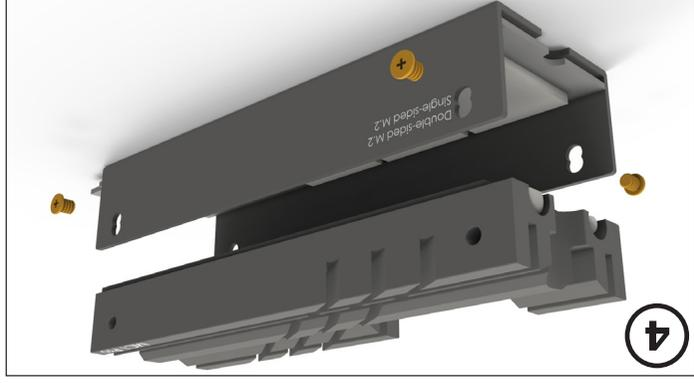
Установите радиатор (1) на накопитель M.2. Наживите винты M2 (3), чтобы соединить радиатор (1) с охлаждающей задней пластиной (2). Слегка нажмите на радиатор (1) для более плотного контакта.
