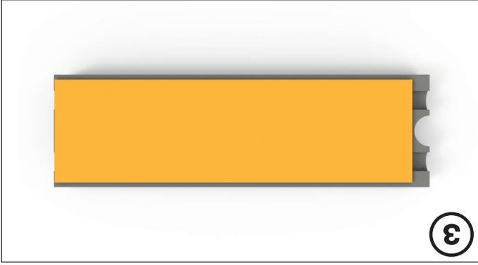
Удалите защитное покрытие с термоподкладки радиатора накопителя M.2 (1).
