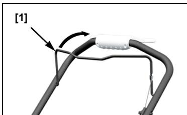
Продолжайте удерживать рычаг включения ножей у рукоятки. Это позволит двигателю и ножам работать плавно и предотвратит преждевременный износ системы управления ножами.
