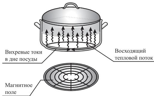
Принцип работы индукционной плиты основан на индукционном нагреве, который представляет из себя нагрев тел в электромагнитном поле за счет теплового действия вихревых электрических токов, протекающих по нагреваемому телу и возбуждаемых в нем благодаря закону электромагнитной индукции.
