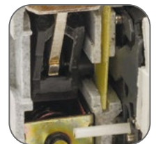
Механизм мгновенной коммутации
