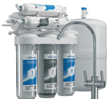
Фильтр предназначен для глубокой очистки питьевой воды. Обратноосмотическая мембрана удаляет частицы до 0,0001 мкм. Установка регулятора давления не более 6 атм в систему перед фильтром обязательна.
