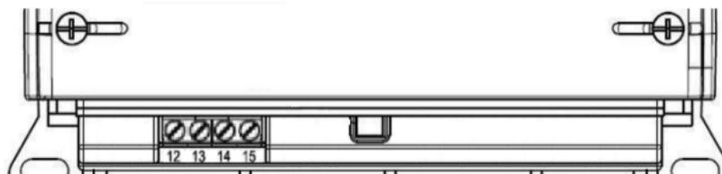
Рисунок 8. Обозначение функциональных контактов счетчика CE318 S35 непосредственного включения
