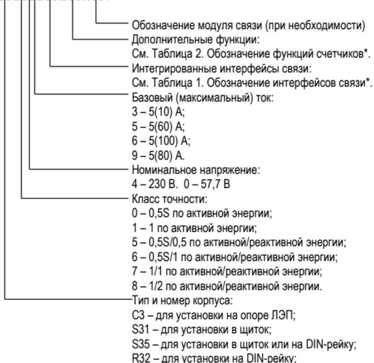
Рисунок 1. Структура условного обозначения счетчиков
