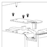
4. Снимите дверь и поместите ее на мягкую поверхность. Затем снимите другую дверь, повторив процесс.
