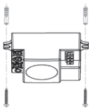
Рис. 8 - Монтаж датчика MW-706
