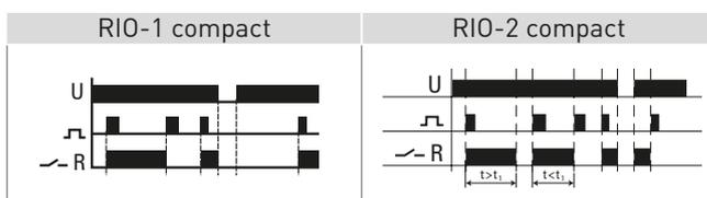
Реле RIO-1 compact не имеет функции памяти, т.е. при исчезновении питающего напряжения контакты размыкаются и после восстановления напряжения питания остаются в разомкнутом состоянии. Реле RIO-2 compact имеет функции памяти, т.е. при исчезновении питающего напряжения контакты размыкаются и после восстановления напряжения питания переходят в замкнутое состояние.
