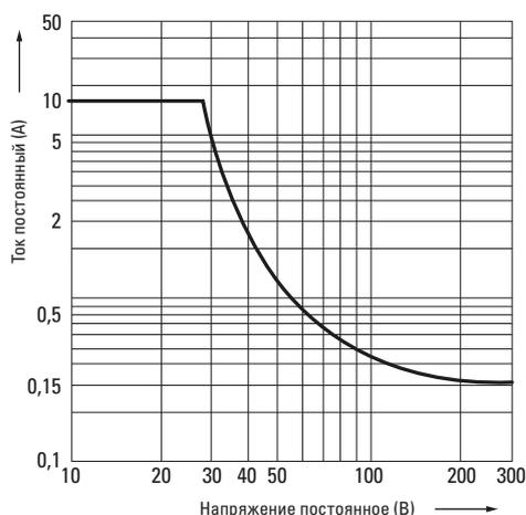
Зависимость коммутационной способности от коммутируемого напряжения.
