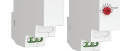
Импульсные реле RIO EKF PROxima предназначены для управления по двухпроводной сети осветительным и другим электротехническим оборудованием из нескольких мест при помощи параллельно соединенных выключателей без фиксации. Это позволяет упростить схему управления, уменьшить потери в сети, а также сократить количество прокладываемого кабеля по сравнению со схемой с проходными выключателями. Схема может работать с выключателями с подсветкой. Возможна коммутация алюминиевым и медным проводом.
