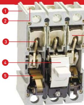
на которой закреплены пружинные подвижные силовые контакты с гибкими соединениями. Рейка поворачивается в боковых направляющих, обеспечивая не только замыкание подвижных и неподвижных силовых контактов, но и необходимые провалы для увеличения и выравнивания силы нажатия на подвижные контакты. Система дугогашения выключателей весьма эффективна и в исполнениях ВН-99-125/125 А и ВН-99-160/160 А.
