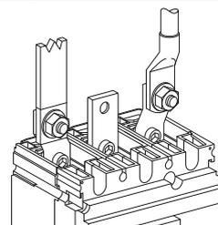
6. Размеры внешних проводников для ВА-99 EKF PROxima (посеребренная медь, поставляются в комплекте с выключателем).
