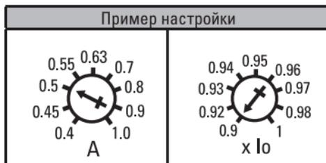
Значение уставки защиты от перегрузок для аппарата ВА-99С 400А при  $I_0 = 0,5$  и  $I_r = 0,9$  будет  $400 \times 0,5 \times 0,9 = 180$  А.
