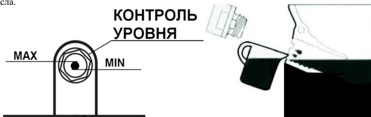
Рисунок 6 – Проверка уровня масла в корпусе редуктора
