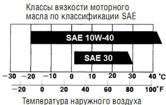
Рисунок 4 – Классы вязкости масла по классификации SAE
