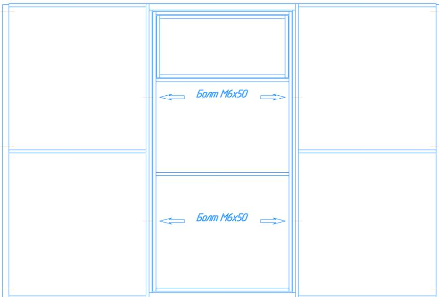
Соедините винтами М6×70 мм, шайбами М6, гайками М6 торец со стартовыми прямыми согласно просверленным в торце отверстиям.
