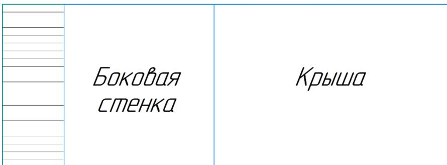
Обратите внимание, что ориентация сот поликарбоната должна быть вертикальная. Разрежьте лист согласно раскроя ножом или электролобзиком. Крепление частей поликарбоната на соответствующие части торца теплицы необходимо проводить в горизонтальном положении для большей точности крепления. Крепление осуществляется винтами 4,2x19 с шайбой EPDM. Для удобства монтажа торец снабжен перемычками, соединяющими двери, форточки и рамы торца, которые должны быть разрезаны после сборки каркаса.
