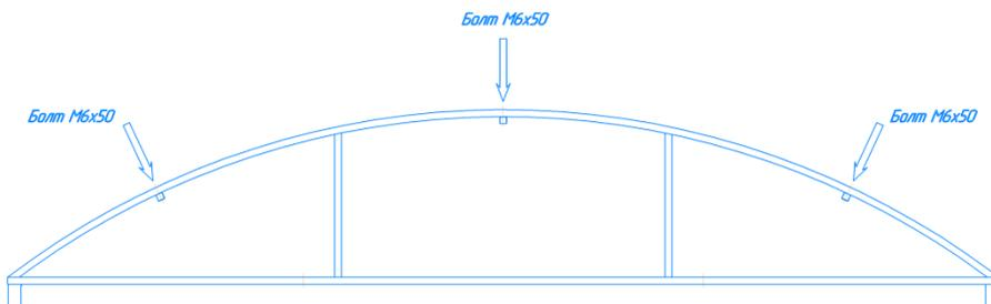
Соедините винтами М6×50 мм, шайбами М6, гайками М6 торцевые панели с дверным блоком согласно просверленных отверстий.
