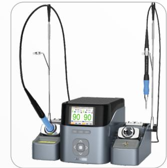
При помещении паяльной ручки в подставку или вертикальный зажим, соответствующий канал переходит в спящий режим, температура жала снижается до установленной температуры в режиме ожидания (90°C по умолчанию).
