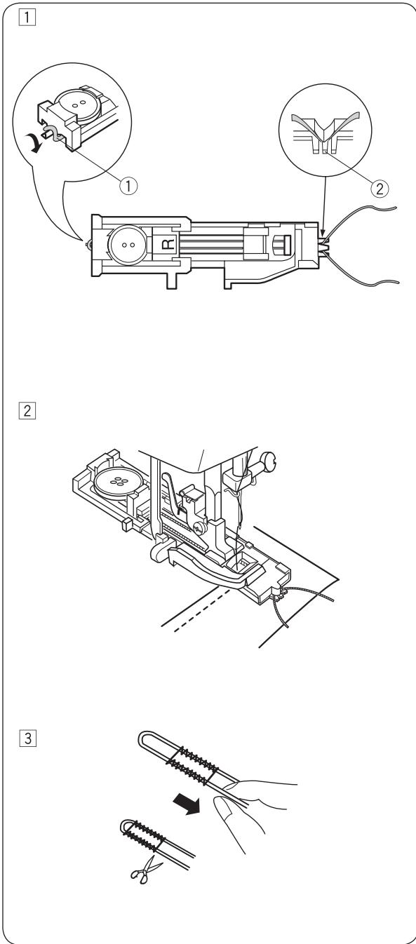
1 Поднимите лапку для автоматического выметывания петли и зацепите вкладную нить за крючок на задней стороне лапки.
