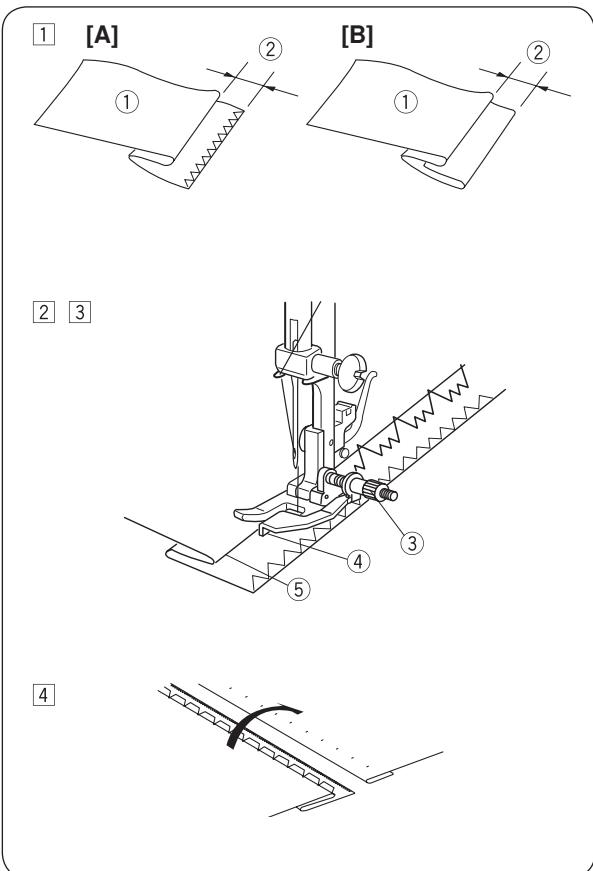
1 При обработке тяжелых тканей, склонных собираться в складки, сначала обработайте край. Затем заложите складку как показано на рисунке с припуском 0,7 см.
