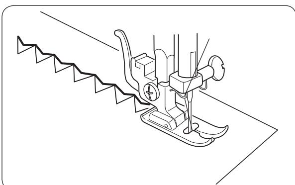
Если при обработке тканей некоторых типов происходит неравномерная подача ткани вперед и назад, необходимо сбалансировать подачу. Для этого регулятор длины стежка следует повернуть следующим образом:
