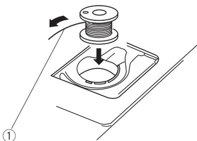
1 Вставьте шпульку в шпуледержатель. Проверьте, чтобы нить разматывалась против часовой стрелки.
