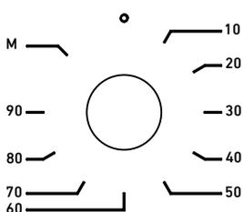
Позволяет установить время приготовления пищи. Вы можете выбрать температуру и тип приготовления, а также отрегулировать время приготовления, поворачивая его по часовой стрелке. По истечении времени он подает предупреждение звуковым сигналом. При желании можно начать приготовление в режиме М, выбрав температуру и тип приготовления, не задавая время.
