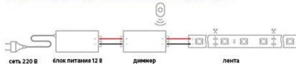
Последовательное подключение одноцветной ленты 12 В до 5 метров с одним блоком питания и диммером
