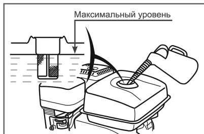
Рис. 13 Максимальный уровень топлива в топливном баке
