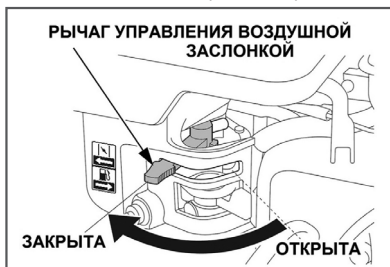
Рис. 15 Рычаг управления воздушной заслонкой PC6337F
